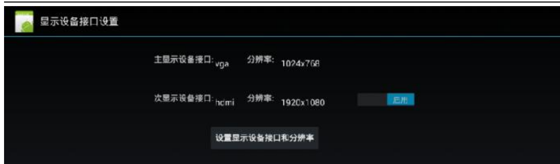
图 4.5 显示设备接口和分辨率设置
