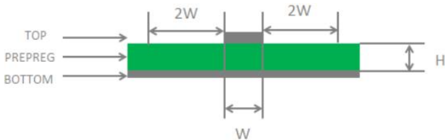
图 4-2 两层 PCB 板微带线结构
