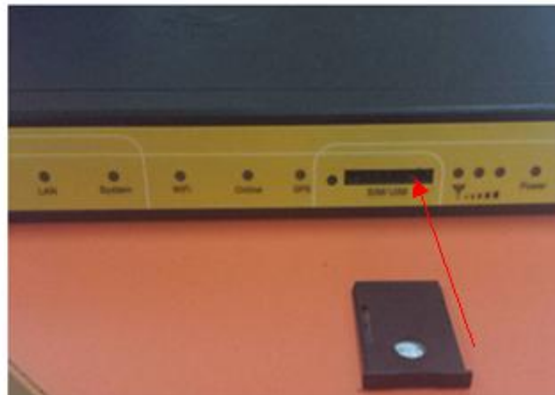
轻触退卡钮, SIM卡槽弹出
