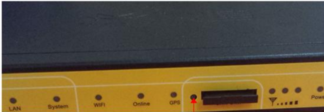
轻触退卡钮, SIM卡槽弹出
